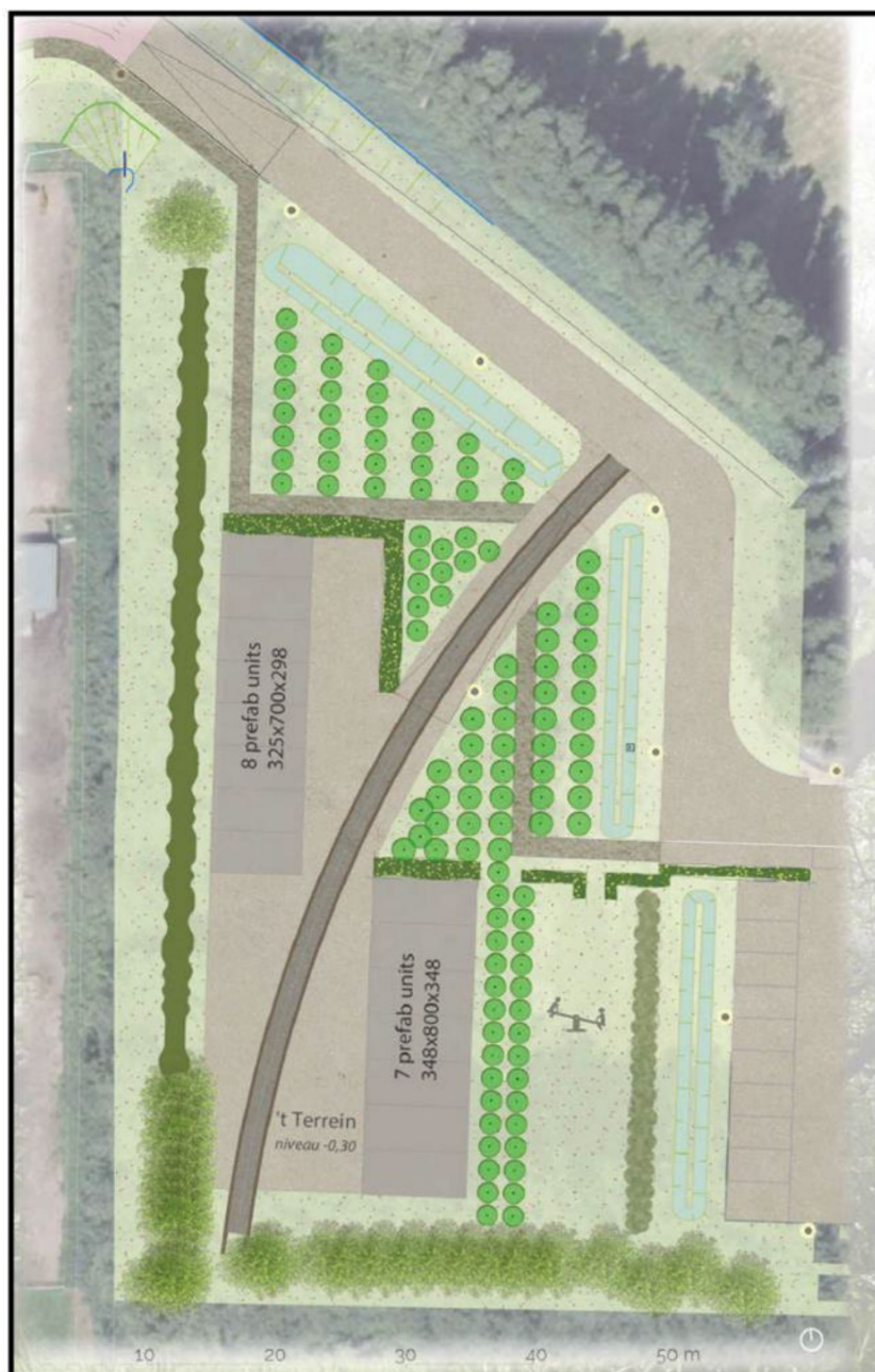
Afbeelding 2.1 Structuurontwerp garageboxen (Bron: Ars Virens)
