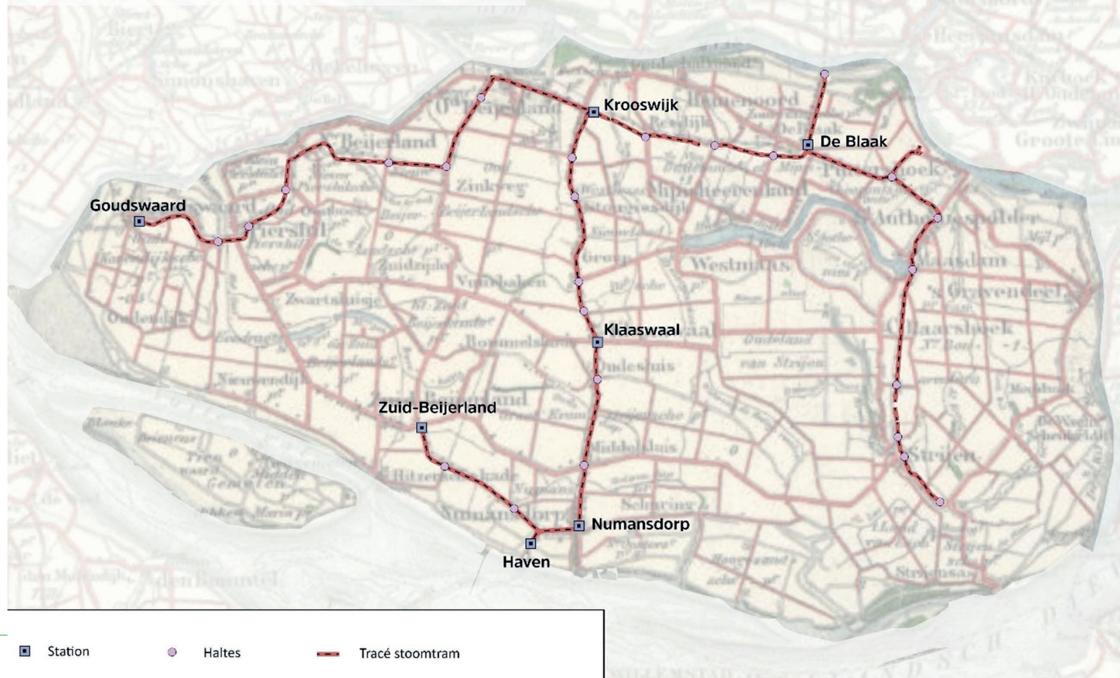
Afb 5.7 Overzicht van het tracé van de stoomtram van de RTM door de Hoeksche Waard, inclusief stations en afzonderlijke haltes. De stations en haltes zijn gekarteerd op basis van de topografische kaart uit 1905
