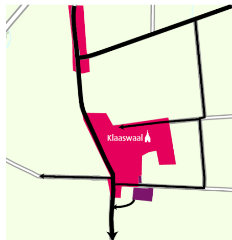
Figuur B1.12: Maatregel 11 - zuidelijke ontsluiting bedrijventerrein
