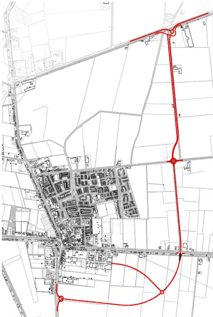
Figuur 8 Schetsontwerp variant 2, bypass met inrichting als erftoegangsweg
