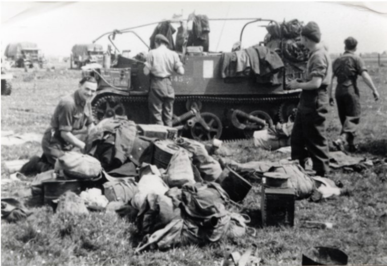
De Brencarrier wordt aangedreven door een Ford V8 motor. Ze staan bekend om hun vering. (Foto: Oudheidkundige Vereniging "Het land van Strijen")
